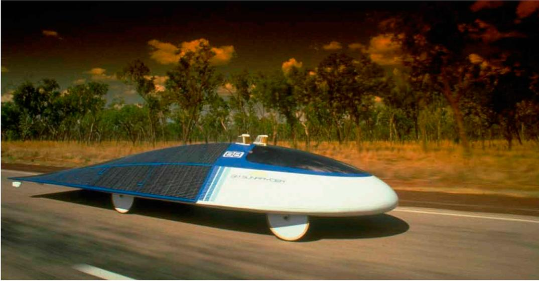
Солнечный автомобиль использует солнечную энергию (или другого источника излучения), которая превращается в электрическую энергию при помощи солнечных батарей. В моторе автомобиля электрическая энергия преобразуется в механическую, которая и обеспечивает движение автомобиля.
